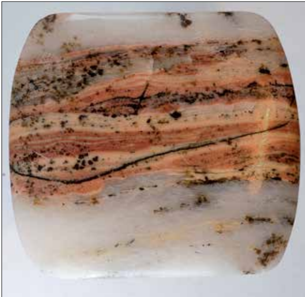
Fig. 21 - Lastrina taglio fantasia di quarzite bianco latte con incluse vene di granato spessartina di colore bruno- aranciato più o meno intenso e ossidi di manganese neri. Dimensioni 29 x 23 mm, massa 12,3 ct (taglio Fabrizio Troilo; fotografia Emanuele Costa e Fabrizio Troilo).
